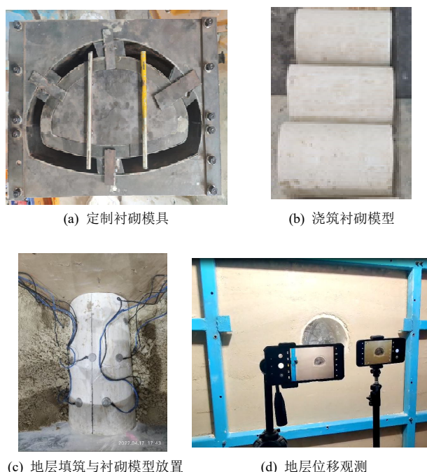
图 6 静力推覆试验的实施
